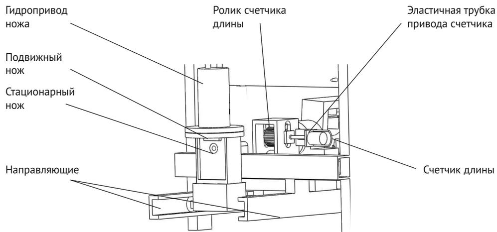
Рис. 3 Система резки
